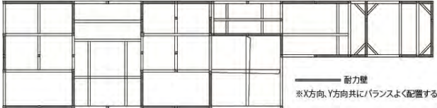
耐力壁の配置例（平面）
